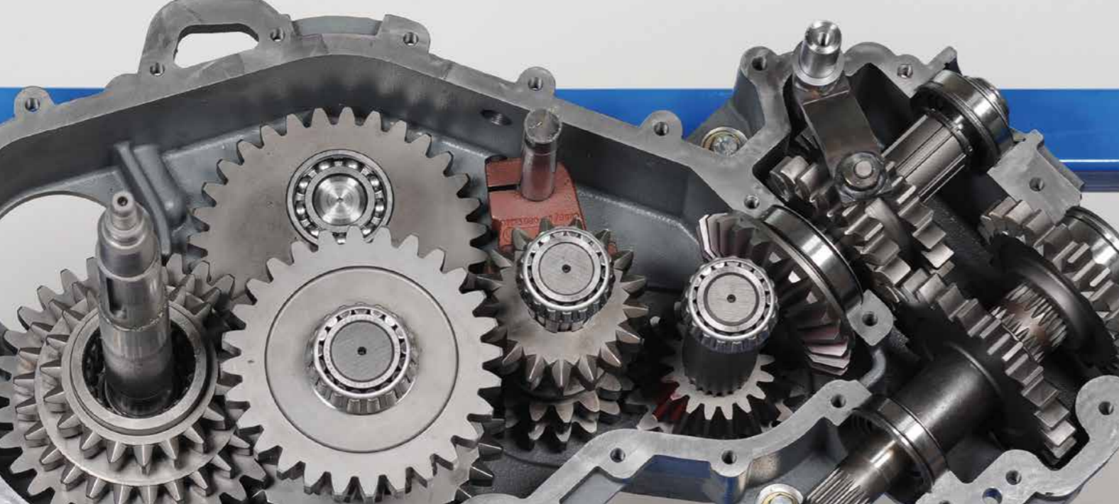
Schaltbares Sondergetriebe für die Landtechnik
