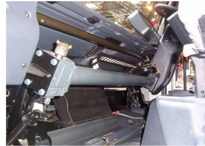
Sondergetriebe für Umstecklenkung beim UNIMOG
